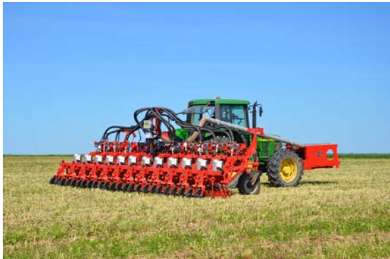
Porte-outil Gaïa, équipé de broyeurs inter-rangs
