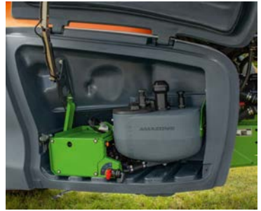
Équipement DirectInject avec bac de 50 l et pompe doseuse montés dans le coffre de rangement de l'UX 01 Super
