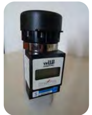
L'utilisation d'un humidimètre est recommandée pour vérifier la teneur en eau de récolte
