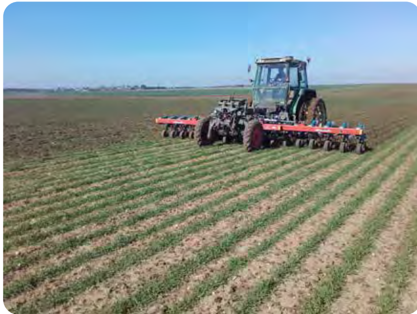
Le passage de la bineuse est conditionné par l'écartement entre les rangs - Photo : GAEC du Coudray
