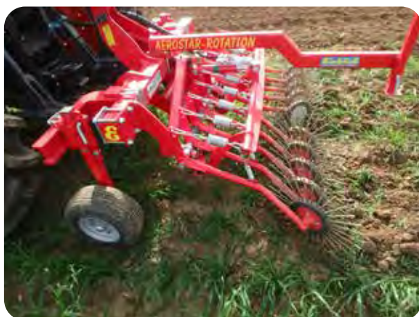
La roto-étrille recouvre de terre les adventices
